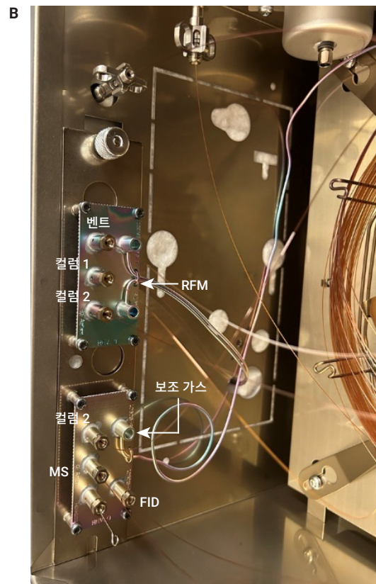
그림 3. 퍼지형 분할기를 사용한 GC × GC RFM 설정. (A) 퍼지형(3방향) 분할기 구성을 사용할 때의 GC × GC 개략도. (B) 퍼지형 분할기와 reverse flow modulator 플레이트가 장착된 GC 오븐을 보여주는 사진.
