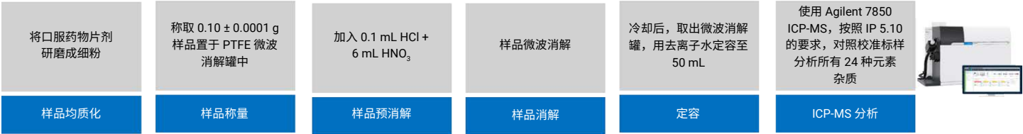
图 1. 使用 Agilent 7850 ICP-MS，按照 IP 通则 5.10 草案分析药品样品中元素杂质的分析工作流程
