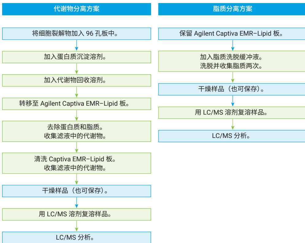
图 2. 细胞裂解物的自动化代谢物 + 脂质双重分离方法 [3] 。绿色步骤由 Agilent Bravo 代谢组学样品前处理平台执行
