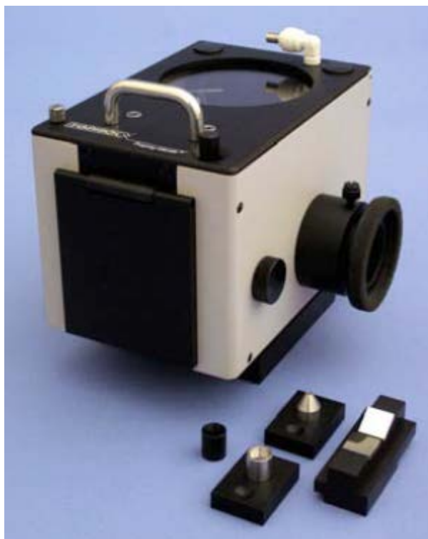
图 2. 带校准工具和粉末池样品杯的 Praying Mantis 附件
