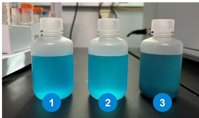
图 3. 三种铜电解液样品，基质为 3% 硫酸。使用配备 ADS 2 自动稀释器的 Agilent 5800 VDV ICP-OES 按原样对这些样品进行分析
