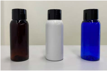
그림 2. 이 연구에 사용된 유색 폴리에틸렌 테레프탈레이트 소재의 플라스틱 용기.
