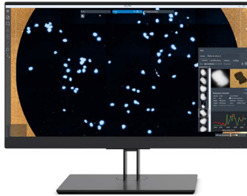
그림 1. Agilent 8700 LDIR 화학 이미징 시스템을 사용하면 시료에 존재하는 입자 수, 입자 크기 및 화학 성분을 포함하여 미세플라스틱을 일상적으로 빠르게 분석할 수 있습니다.
