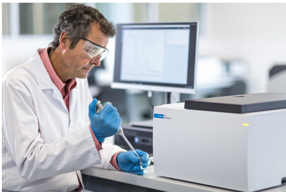
图 2. Agilent Cary 3500 紫外-可见多池分光光度计可用于在八个比色皿位置同时执行最多四个温控实验
