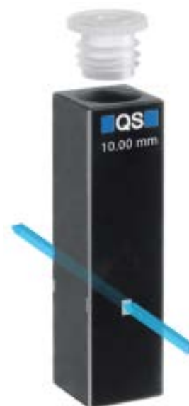
图 3. 本研究所用的安捷伦超微量比色皿。Agilent Cary 3500 紫外-可见分光光度计的极小的聚焦光束可透过永久光学准直的小孔，无需调整
