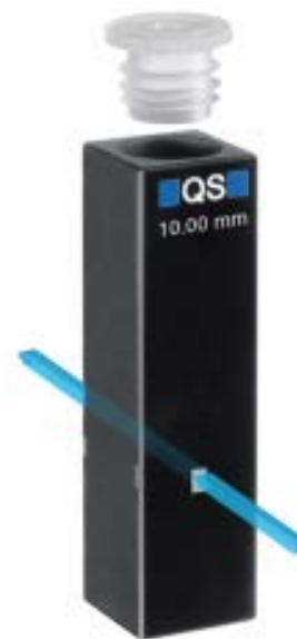
Figura 3. Ultramicrocela Agilent usada neste estudo. O feixe extremamente pequeno e com foco do espectrofotômetro UV-Vis Cary 3500 Agilent passa por aberturas pequenas e permanentemente alinhadas que não precisam de ajustes.
