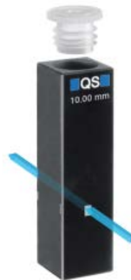
그림 3. 이 연구에 사용된 애질런트 울트라 마이크로셀. Agilent Cary 3500 UV-Vis 분광 광도계의 아주 작고 집중된 빔이 조정이 필요 없는 영구적으로 정렬된 작은 구멍을 통과합니다.
