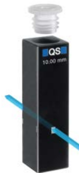
Figura 3. Microcella ultra Agilent usata nello studio. Il fascio luminoso estremamente piccolo e focalizzato dello spettrofotometro UV-Vis Agilent Cary 3500 attraversa le piccole aperture che sono permanentemente allineate e non richiedono regolazioni.
