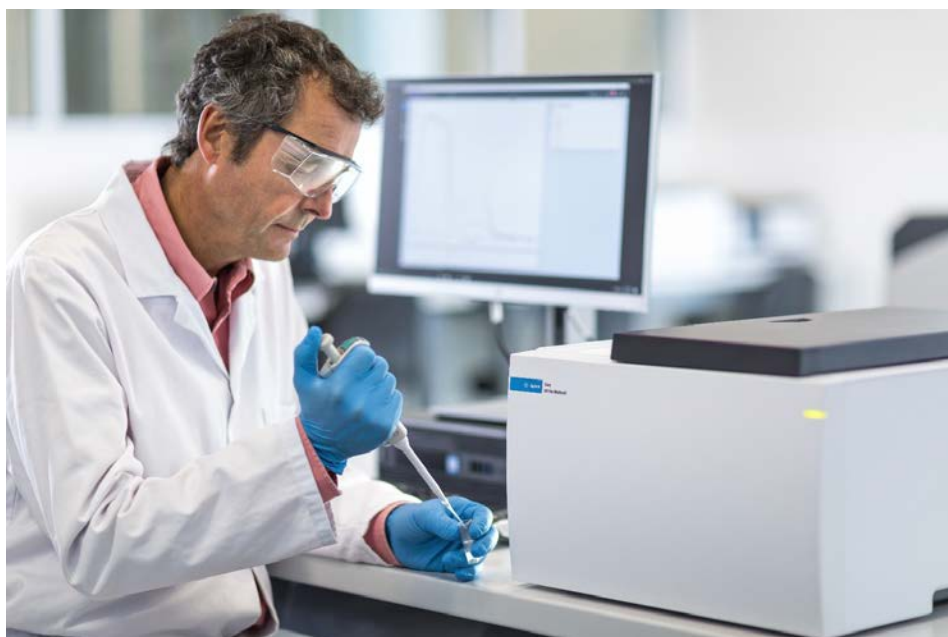
Figure 2. Le spectrophotomètre UV-Vis Agilent Cary 3500 multicuve peut être utilisé simultanément pour quatre expériences de température sur huit positions de cuvette.
