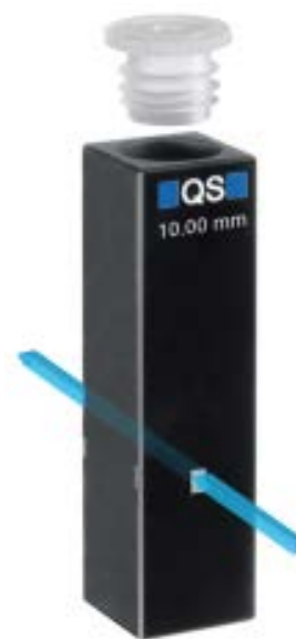
Figure 3. Cellule ultra-micro Agilent utilisée dans cette étude. Le faisceau focalisé extrêmement petit du spectrophotomètre UV-Vis Agilent Cary 3500 passe à travers de petites ouvertures optiques qui sont constamment alignées et n'ont pas besoin d'être réglées.
