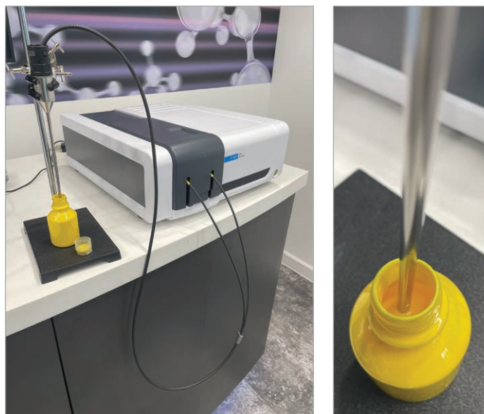
图 3. 使用 Agilent Cary 60 紫外-可见分光光度计和 Hellma Katana XP 6 ATR 光纤探头测量黄色油漆
