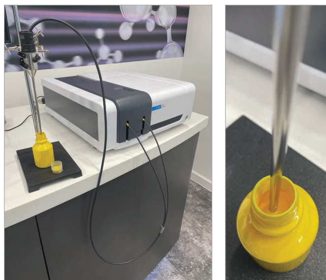
図 3. 黄色塗料を、Hellma Katana XP 6 ATR 光ファイバープローブを備えた Agilent Cary 60 UV-Vis 分光光度計を使用して測定している様子
