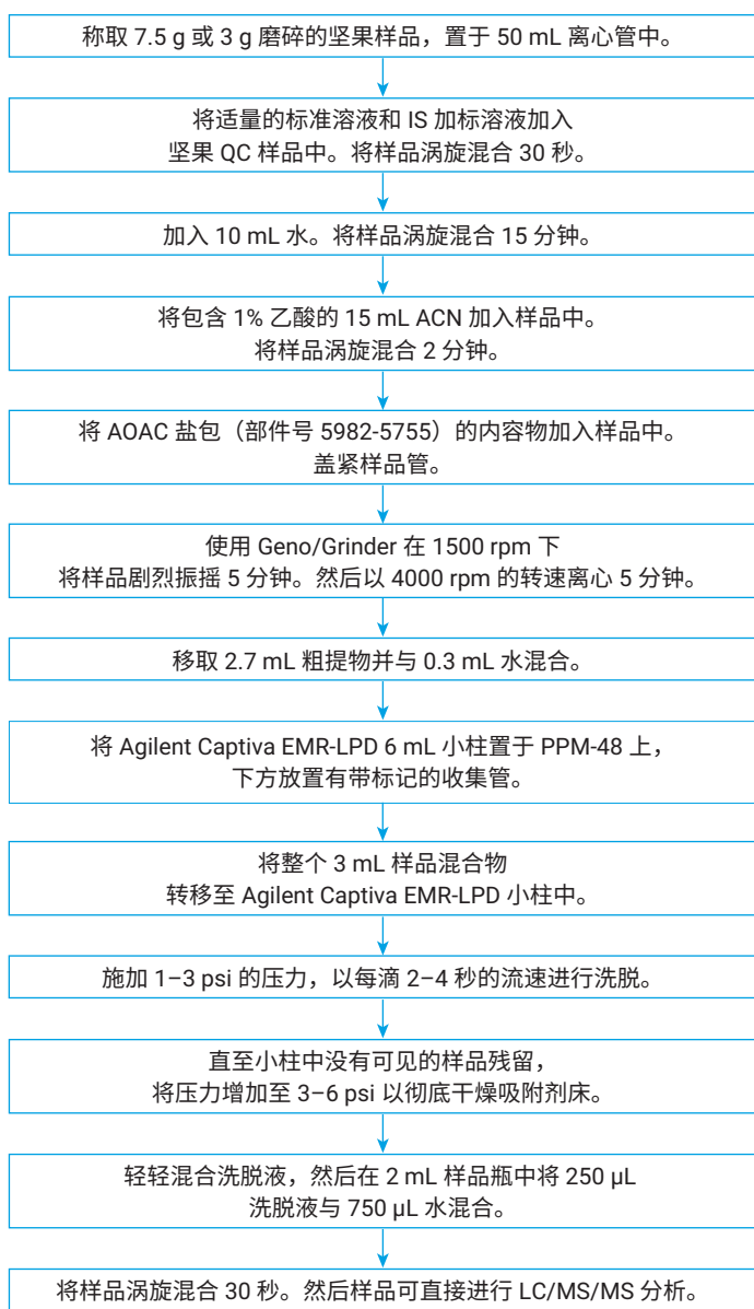
图 2. 使用 Agilent Bond Elut QuEChERS AOAC 萃取以及 Agilent Captiva EMR-LPD 直通式净化的坚果样品前处理流程。对于杏仁、山核桃和腰果，使用 7.5 g 磨碎的样品。对于榛子，使用 3 g 磨碎的样品
