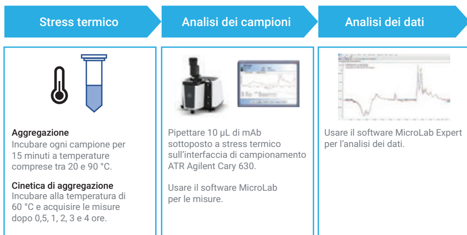
Figura 3. Flusso di lavoro dell'analisi dell'aggregazione di rituximab innovatore e biosimilare con lo spettrometro FTIR Agilent Cary 630.
