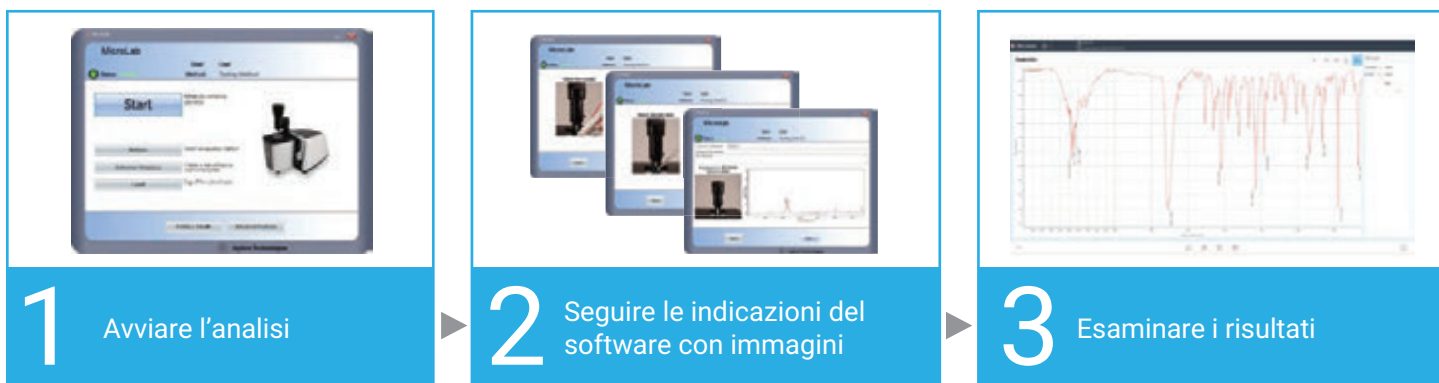
Figura 2. L'intuitivo software MicroLab di Agilent per lo spettrometro FTIR Agilent Cary 630 accompagna l'utilizzatore lungo l'intero flusso di lavoro delle analisi, riducendo le esigenze di formazione e il rischio di errori dell'operatore.
