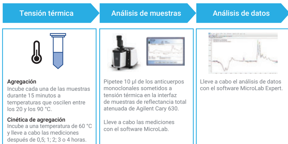
Figura 3. Flujo de trabajo de agregación del análisis de rituximab original y biosimilar mediante Agilent FTIR Cary 630.
