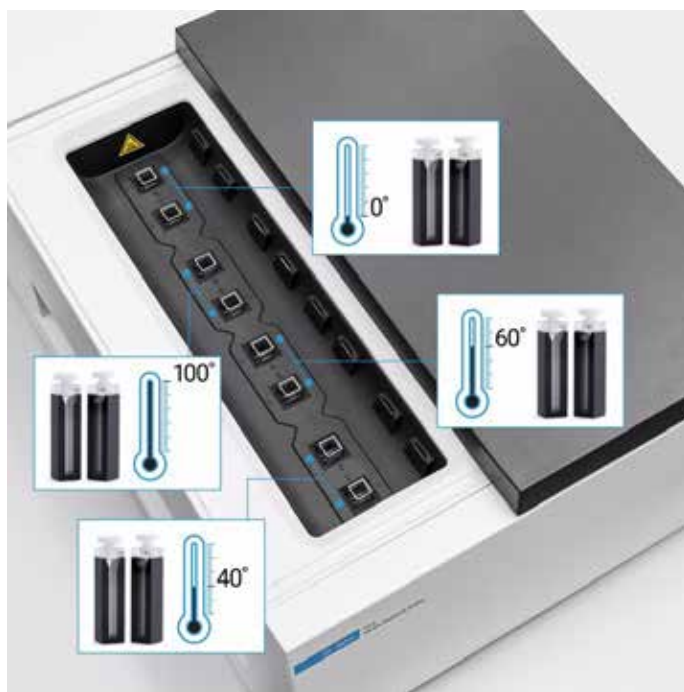
Figure 2. Un spectrophotomètre UV-Vis Cary 3500 Multicuves Peltier Agilent avec le module complémentaire logiciel Multizone ; jusqu'à quatre zones de température indépendantes peuvent être configurées, permettant des expériences simultanées à différentes températures dans chaque paire de cuvettes.
