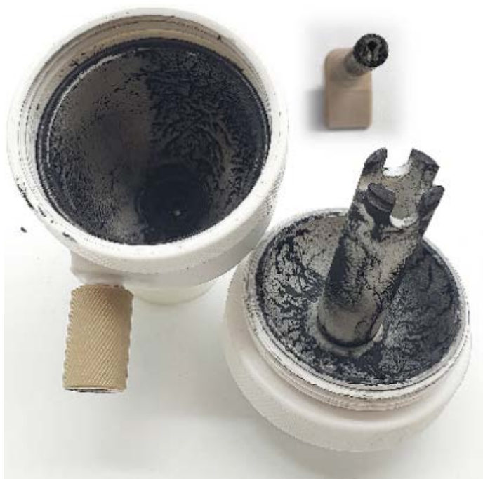
图 5. 实验结束时雾化室和惰性安捷伦 V 型槽雾化器的状态
