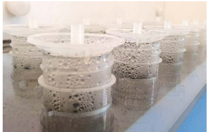
그림 2. 고온 블록 분해기에 들어 있는 BM 시료.
