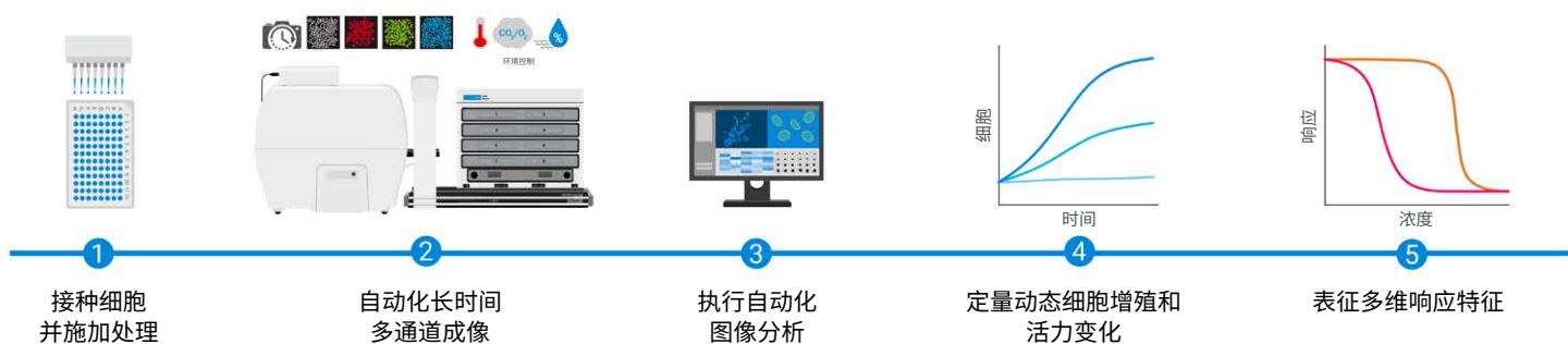
图 1. 安捷伦 BioTek Cytation 9 多功能微孔板检测仪和 BioSpa 8 全自动培养箱上的通用增殖与活力检测工作流程。将相关细胞模型接种至检测板并加入处理化合物，在成像开始前加入活力指示剂。BioSpa 8 全自动培养箱将微孔板传送至 Cytation 9，随时间进行自动化多重成像和分析。Gen5 软件提供分析工具，用于详细的动力学增殖和活力分析，从而获得关于处理特征的定量信息
