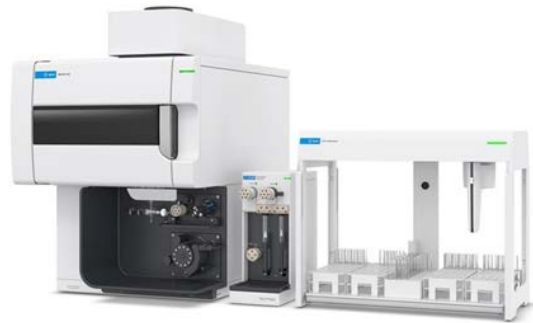
그림 1. AVS 스위칭 밸브(왼쪽), Agilent ADS 2(가운데) 및 Agilent SPS 4 자동 시료 주입기(오른쪽)가 통합된 Agilent 5800 VDV ICP-OES.
