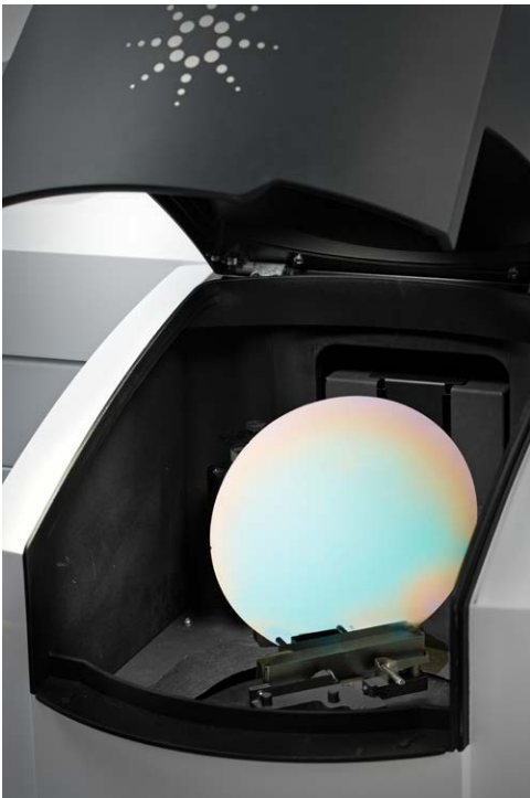
그림 1. 200mm 직경의 실리콘 웨이퍼 시료가 측정 챔버에 장착된 Agilent Cary 7000 UMS.
