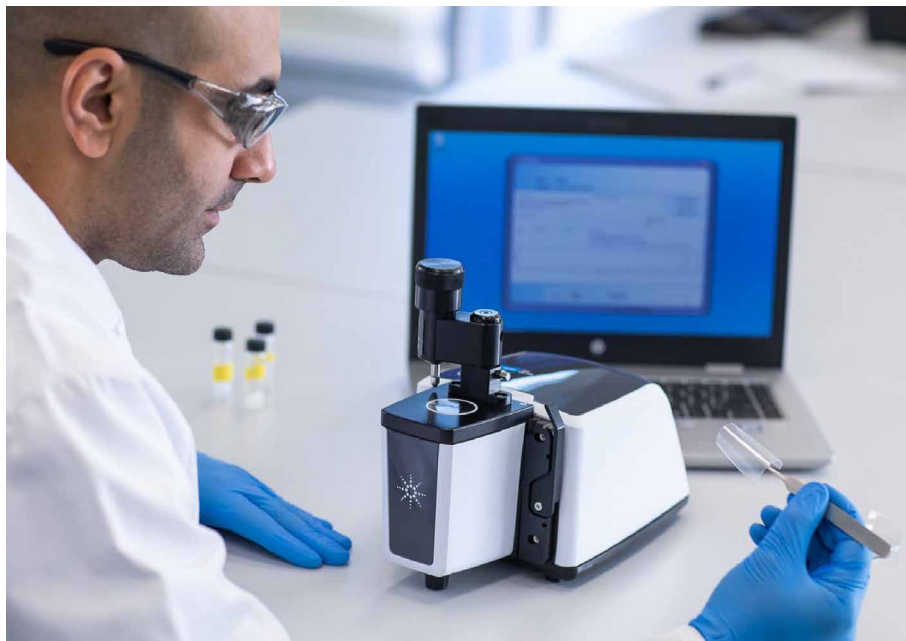
図 5. ダイヤモンド ATR アタッチメントと組み合わせた Agilent Cary 630 FTIR。
