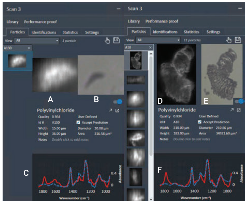
Figure 9. Informations sur la taille et la qualité de touche des particules de l'échantillon 2 obtenues avec le logiciel Agilent Clarity. (A) Image IR de la particule A130. (B) Image dans le visible de la particule A130. (C) Superposition du spectre de A130 (ligne rouge) et du spectre correspondant de la bibliothèque (tirets bleus). (D) Image IR de la particule A10. (E) Image dans le visible de la particule A10. (F) Superposition du spectre de A10 (ligne rouge) et du spectre correspondant de la bibliothèque (tirets violets).
