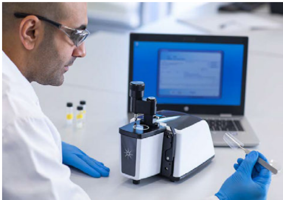
Figura 5. Espectrómetro FTIR Agilent Cary 630 combinado con un módulo ATR con diamante.
