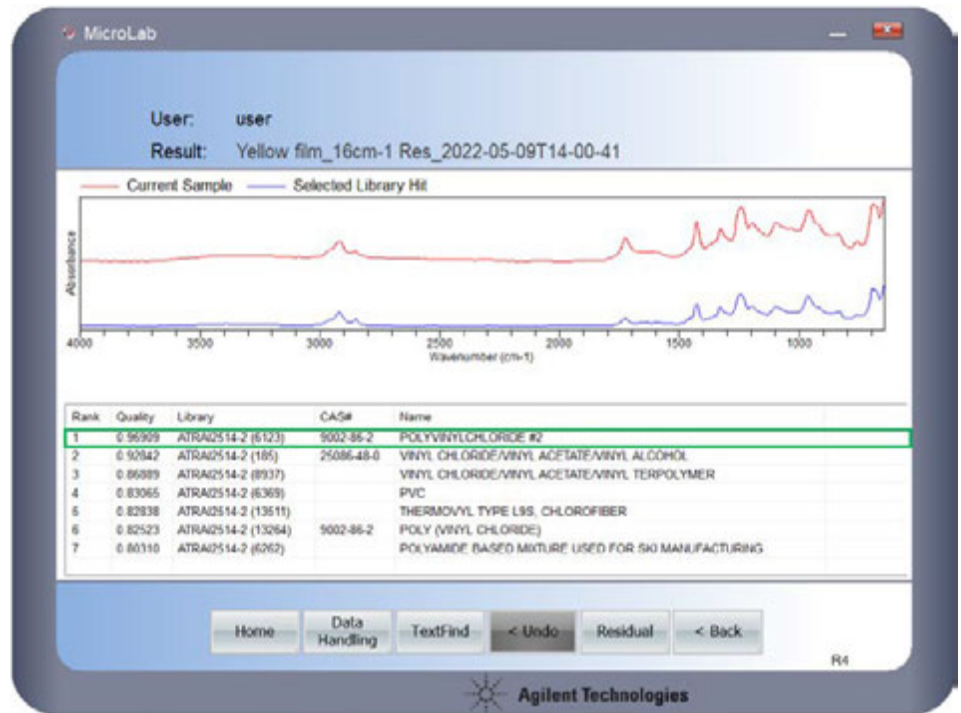
Figura 11. Análisis cuantitativo FTIR Agilent Cary 630 de la muestra 2 (traza roja); coincidencia de la biblioteca (traza azul). En la tabla se muestran la calidad de la coincidencia, la biblioteca empleada y el nombre de la coincidencia.
