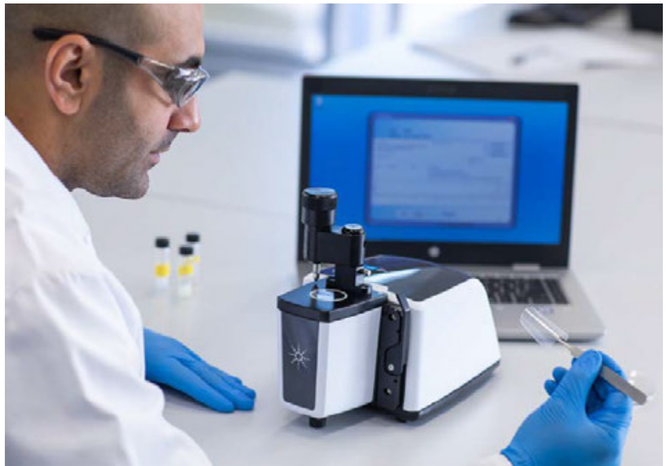
Abbildung 5. Agilent Cary 630 FTIR-Spektrometer, gekoppelt mit einem Diamant-ATR-Probenzubehörmodul.
