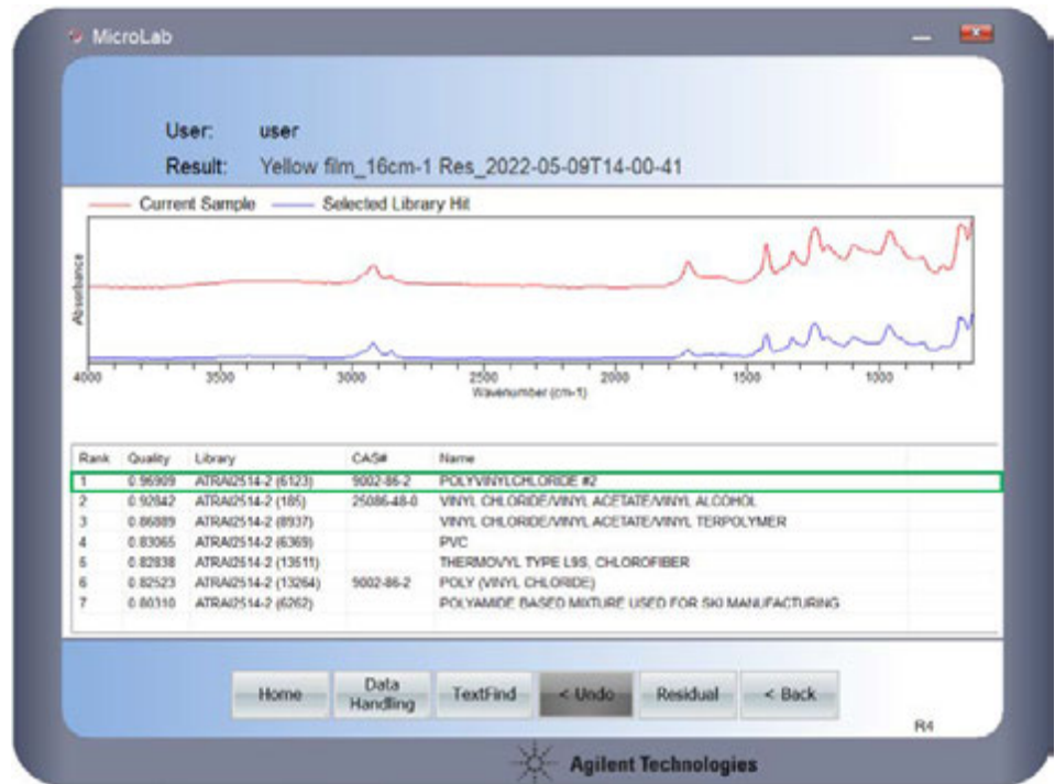
Abbildung 11. Qualitative Analyse von Probe 2 mit dem Agilent Cary 630 FTIR (rote Kurve); Bibliothekstreffer (blaue Kurve). HQI, verwendete Bibliothek und Name des Treffers sind in der Tabelle zusammengefasst.
