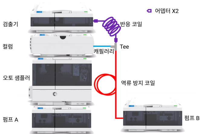
그림 1. 비타민 B1 분석을 위한 Agilent Infinity II HPLC 시스템 도식도
