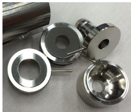
図 5. 約 1800 回注入後のイオン源状態
