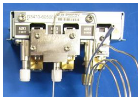
図 4. キャリアガス切り替えスイッチモジュール
