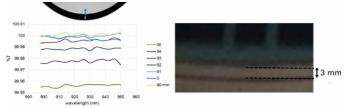
図 5. 左：90 mm から 95 mm まで 1 mm 刻みで測定し、測定可能な最大エッジポイントを確認しました。95 mm での透過率の低下は、ビームがサンプルホルダの端をクリッピングしていることを示しています。右：コーティングはウエハの端から 3 mm の場所まで到達しています。
