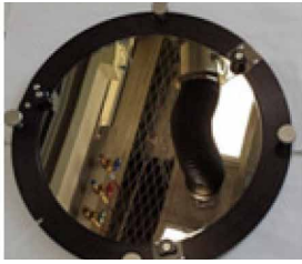
図 3. ソリッドオートサンブラに装着する8 インチのサンプルホルダに取り付けられた直径 200 mm のプレカットウエハ
