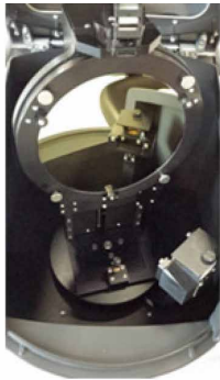
図 4. Agilent ソリッドオートサンブラが装着され、直径 200 mm のコーティングされたウエハを保持している Cary 7000 UMA サンプルコンパートメントの正面図
