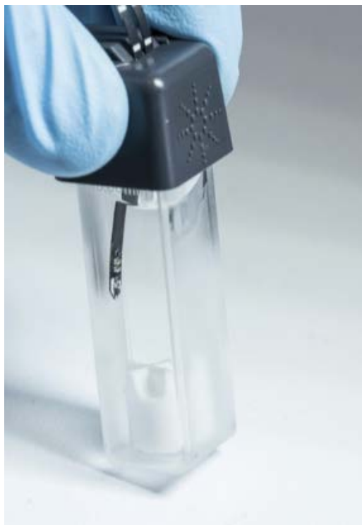
图 2. 比色皿内温度探头，用于在测量期间控制实验温度
