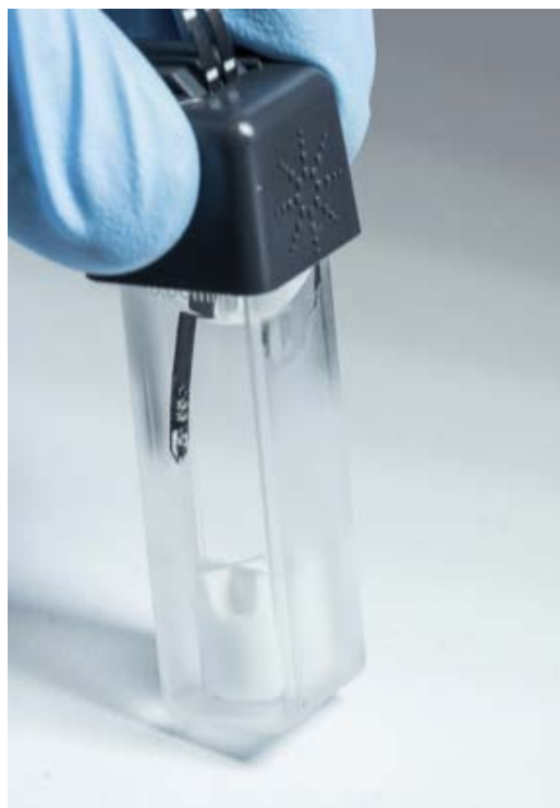
Рисунок 2. Погружной температурный зонд, с помощью которого контролировалась температура в ходе эксперимента.
