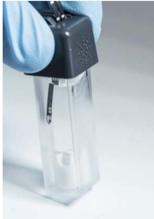
그림 2. 측정 동안에 실험 온도를 제어하기 위해 사용된 in-cuvette 온도 프로브
