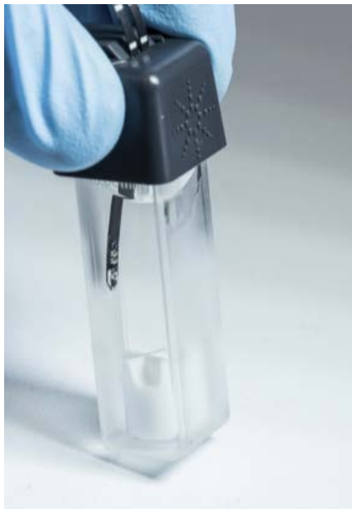
Figure 2. Sonde de température interne utilisée dans chaque cuve pour régler la température expérimentale pendant les mesures.
