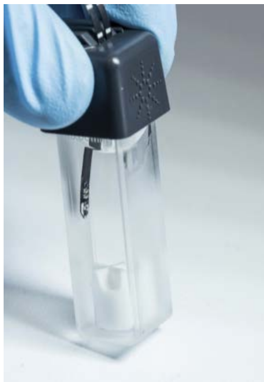
Figura 2. La sonda de temperatura en la cubeta, utilizada para controlar la temperatura del experimento durante las medidas.
