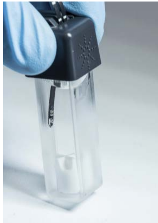
Abbildung 2. Temperatursonde zur Verwendung in den Küvetten: wird zur Steuerung der Temperatur während der Messungen verwendet.
