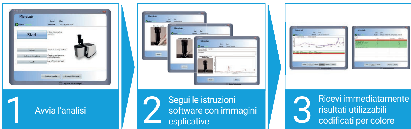
Figura 3. Il software Agilent MicroLab riconosce automaticamente il modulo di campionamento collegato e applica i parametri appropriati. Il software guida l'utilizzatore passo a passo attraverso il flusso di lavoro analitico con l'ausilio di immagini esplicative. I risultati contrassegnati con codici cromatici, visualizzati direttamente al termine dell'acquisizione dei dati, rendono la revisione dei dati semplice e intuitiva.
