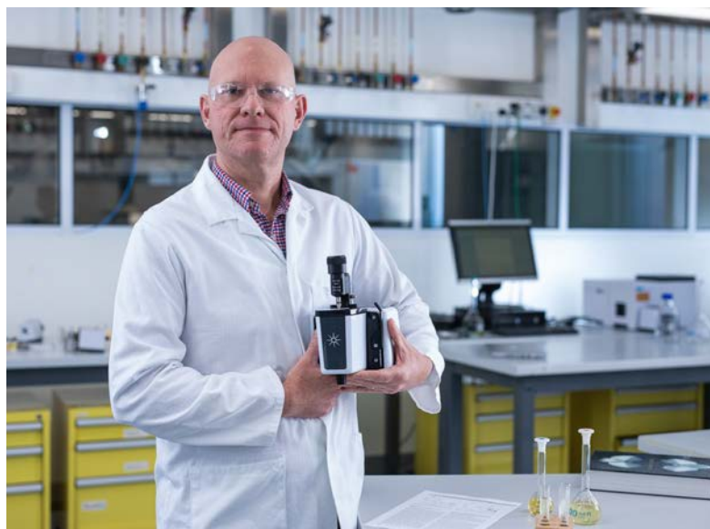
Figura 2. Lo spettrometro FTIR Agilent Cary 630 con il modulo di campionamento in diamante a riflettanza totale attenuata collegato.
