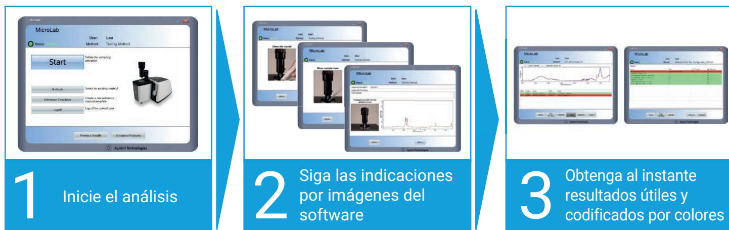
Figura 3. El software Agilent MicroLab reconoce automáticamente el módulo de muestreo acoplado y aplica los parámetros correctos. El software acompaña al usuario, paso a paso, por el flujo de trabajo analítico mediante imágenes con instrucciones. Gracias a los resultados, que se codifican con colores y se notifican directamente tras la adquisición de datos, la revisión de datos resulta rápida e intuitiva.
