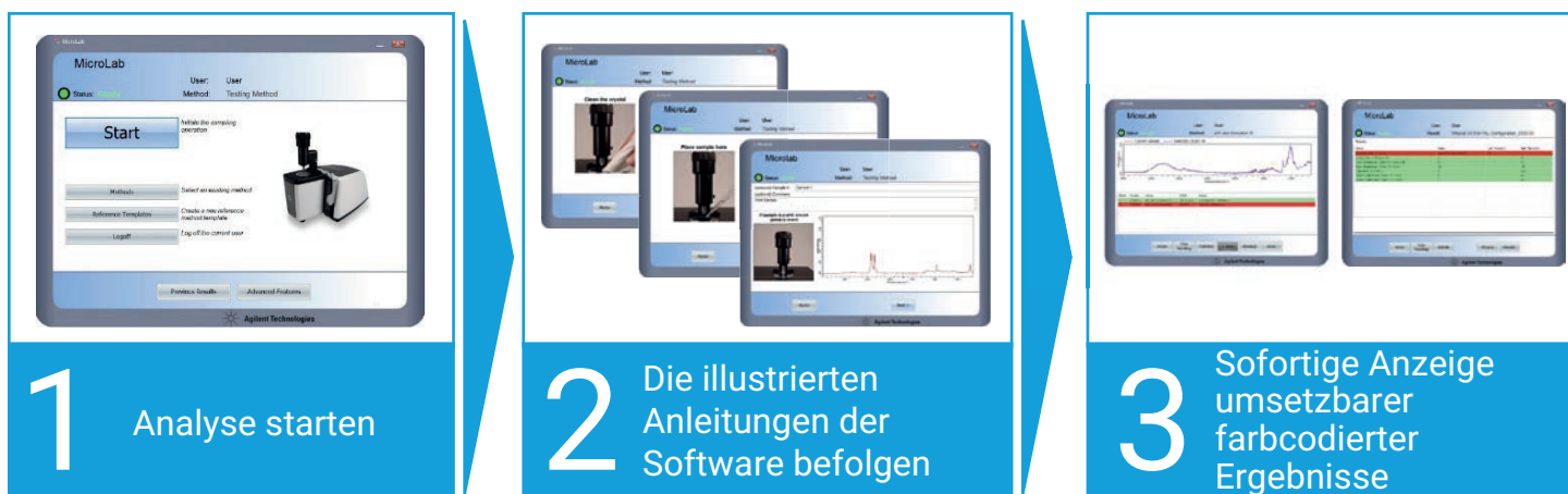
Abbildung 3. Die Agilent MicroLab-Software erkennt automatisch das eingesetzte Probenerfassungsmodul und wendet die entsprechenden Parameter an. Die Software begleitet den Anwender mit schrittweisen Anleitungen und anschaulichen Bildern durch den gesamten analytischen Arbeitsablauf. Die farbcodierten Ergebnisse, die direkt nach der Datenerfassung angegeben werden, ermöglichen eine schnelle und intuitive Überprüfung der Daten.
