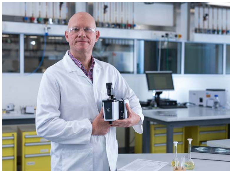
Abbildung 2. Agilent Cary 630 FTIR-Spektrometer mit einem Diamant-Probenerfassungsmodul für abgeschwächte Totalreflexion (ATR).
