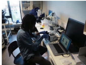
在实验室中使用 Cary 630 FTIR 进行大颗粒塑料样品定性分析
