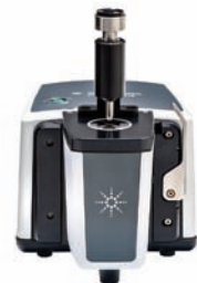
在实验室中使用 Cary 630 FTIR 进行大颗粒塑料样品定性分析
