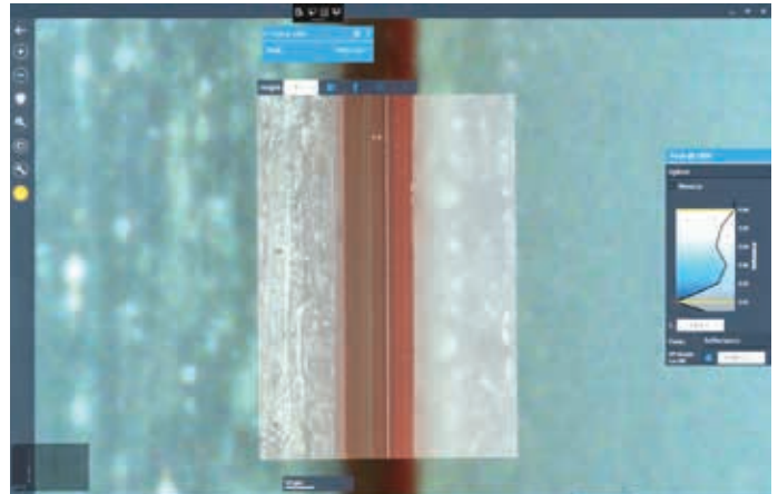
Figure 1. Image haute résolution en lumière visible du stratifié (en rouge) prise en sandwich entre les matériaux de support en plastique du porte-échantillon (en blanc).
