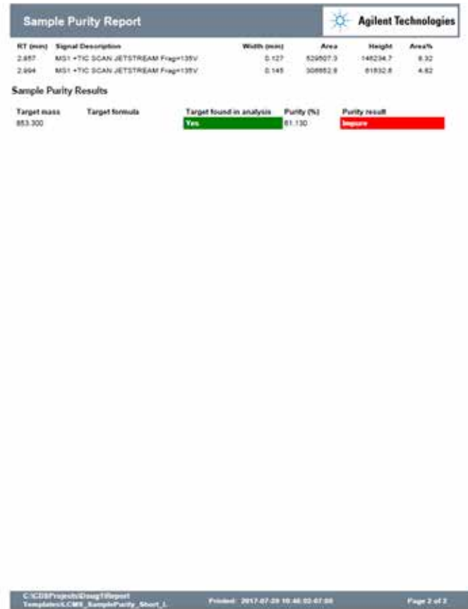
Рис. 6. Типовой отчет о чистоте пробы. В данном случае была задана минимальная чистота 80% по данным сигнала TIC. Паклитаксел был найден (зеленый цвет), однако его чистота была только 61%, что значительно ниже предельной (красный цвет).
