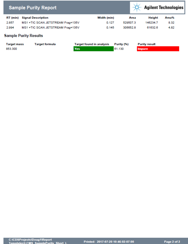
그림 6. 일반적인 시료 순도 보고서. 이 경우에는 TIC 신호에 기반을 둔 80%의 순도 한계값이 지정되었습니다. Paclitaxel이 검출되었으나(녹색으로 표시), 시료 내 Paclitaxel의 순도는 61%로 한계값 수치(빨간색으로 표시) 아래였습니다
