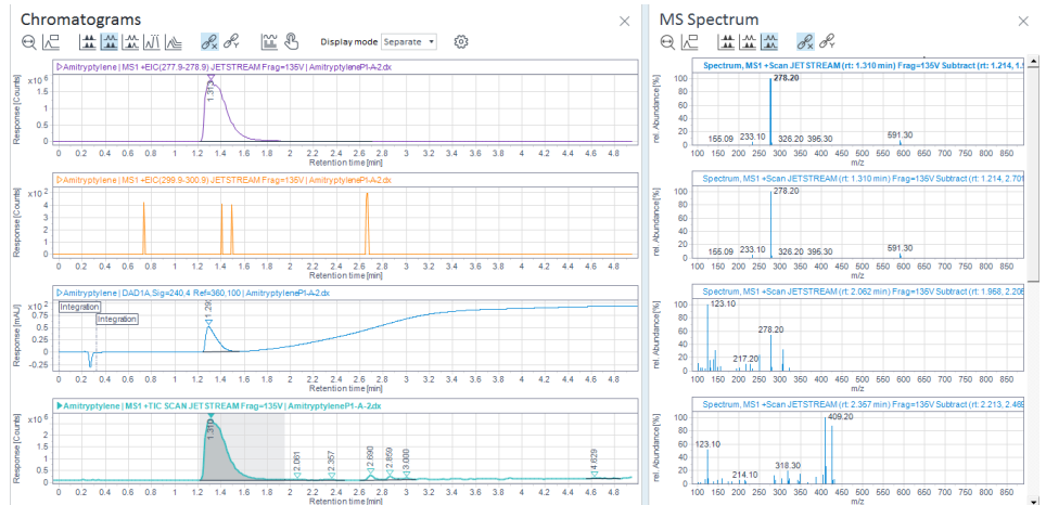
그림 5. Amitriptyline에 대한 특정 시료 데이터 검토는 EIC, TIC, UV 신호, TIC에 적분된 피크에 대한 질량 스펙트럼을 나타냄
