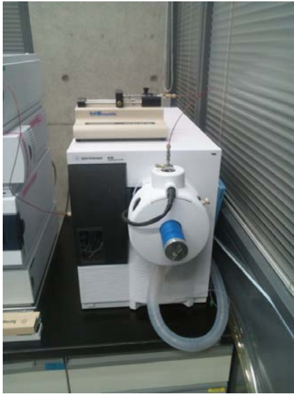
그림 3. MassWorks를 이용한 accurate mass 보정에 사용되는 보정물질 주입용 인퓨전 펌프가 설치된 ASAP/MS 시스템의 구성
