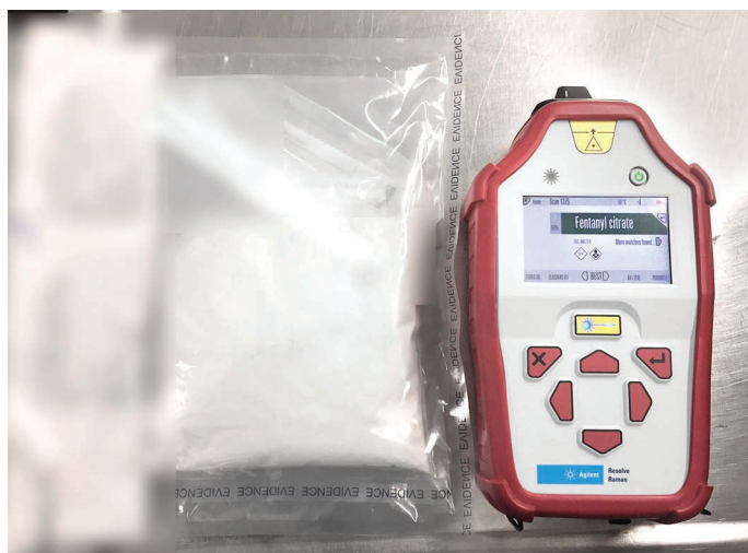
图 3. 穿透多层塑料包装测试芬太尼
