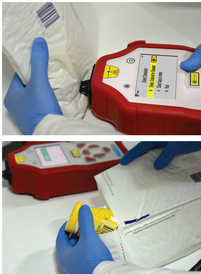
图 1. Agilent Resolve 系统的独特功能可以穿透多层不透明包装进行测试, 无需预先具备任何样品相关知识。本例是装在不透明塑料袋和信封袋内的药丸
