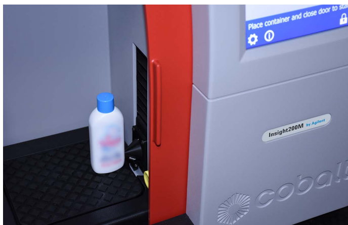
图 3. 使用 Insight200M 系统筛查 100 mL 容器
