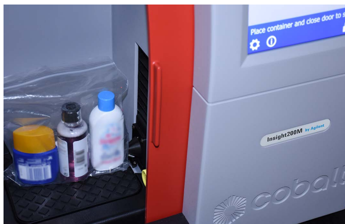
图 4. 透过 1 L 塑料袋筛查 100 mL 容器
