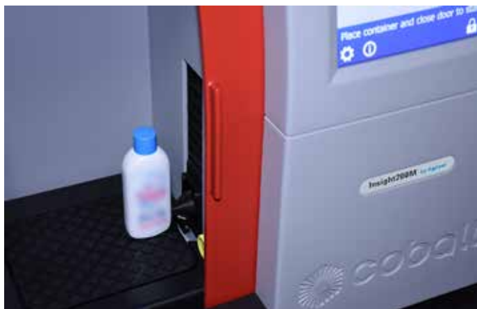
Figura 3. Screening di un contenitore da 100 mL in un sistema Insight200M
