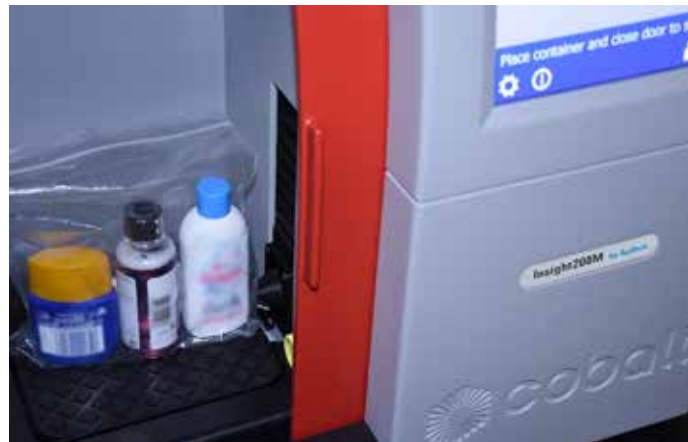
Figure 4. Contrôle d'un contenant de 100 mL encore à l'intérieur d'un sac en plastique de 1 L.
