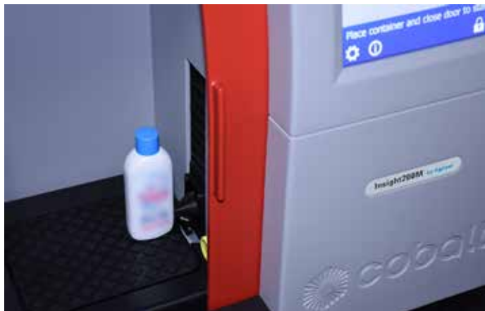
Figura 3. Inspección de un contenedor de 100 ml en un sistema Insight200M
