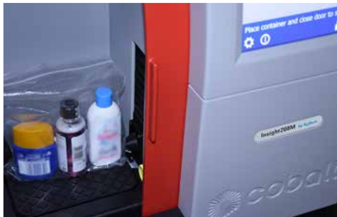
Figura 4. Inspección de un contenedor de 100 ml situado dentro de una bolsa de plástico de 1 l
