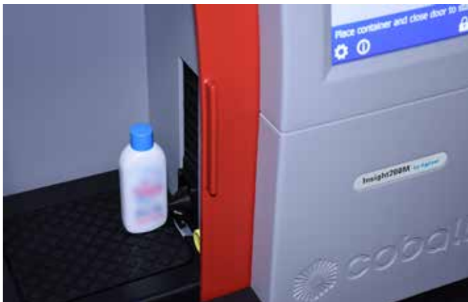
Abbildung 3: Screening eines 100-ml-Behälters mit einem Insight200M-System
