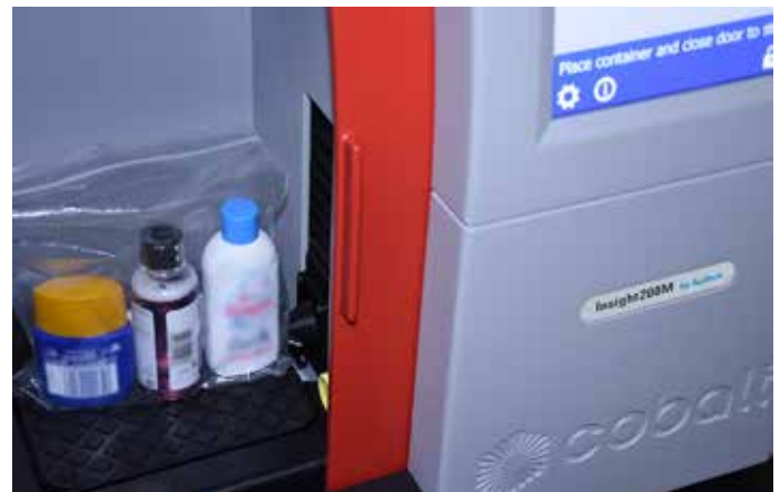
Abbildung 4: Screening eines 100-ml-Behälters in einem 1-l-Kunststoffbeutel mit einem Insight200M-System
